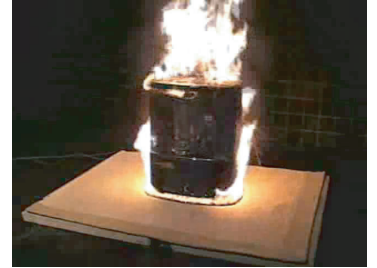
ガソリンで異常燃焼を起こして発火したようす (NITE再現実験)
